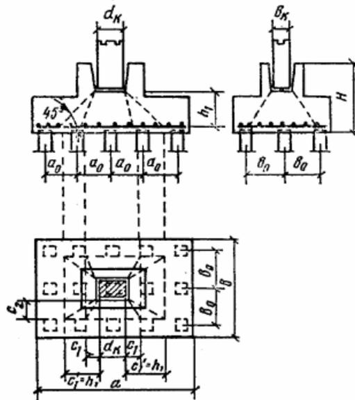
Рис. 1. Схема расчета ростверка на продавливание колонной
