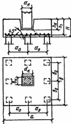
Рис. 2. Схема расчета нижней плиты ростверка на продавливание угловой сваей
