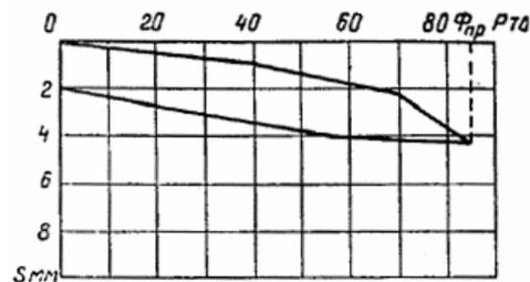
Рис. 15. График испытания свай статической нагрузкой
