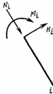
Рис. 4. Положительные направления усилий, передаваемых от ростверка на сваю
