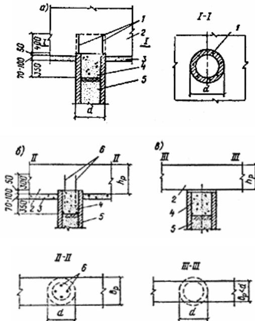
**Рис. 33. Примеры конструктивного решения сопряжения железобетонных полых круглых свай диаметром 300 — 800 мм, работающих на нормальные сжимающие усилия, не выходящие за пределы ядра сечения свай, с железобетонными ростверками**
