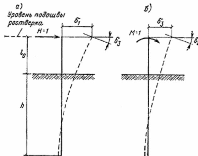
Рис. 3. Схемы перемещений свай со свободным верхним концом от действия
