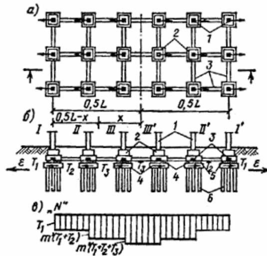
**Рис. 42. Схема свайного фундамента для каркасного здания при наличии связей-распорок в двух направлениях и ростверка, отделенного от фундамента швом скольжения**
