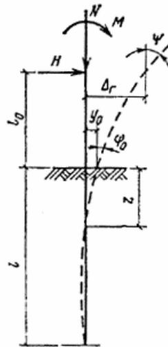
Рис. 1(1). Схема нагрузок на сваю
