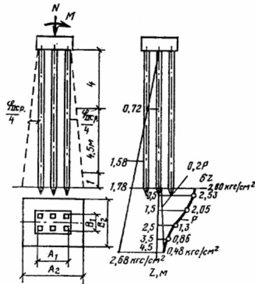
Рис. 22. Схема определения размеров условного фундамента
