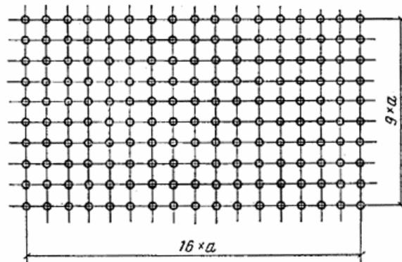
Рис. 26. Пример расположения свай в виде «свайного поля»
