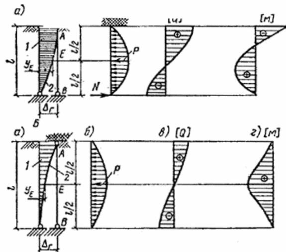
**Рис. 49.** Схемы взаимодействия коротких свай-стоек с низким ростверком при действии горизонтального перемещения грунта
