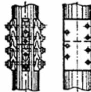
**Рис. 1. Стыки деревянных свай**
