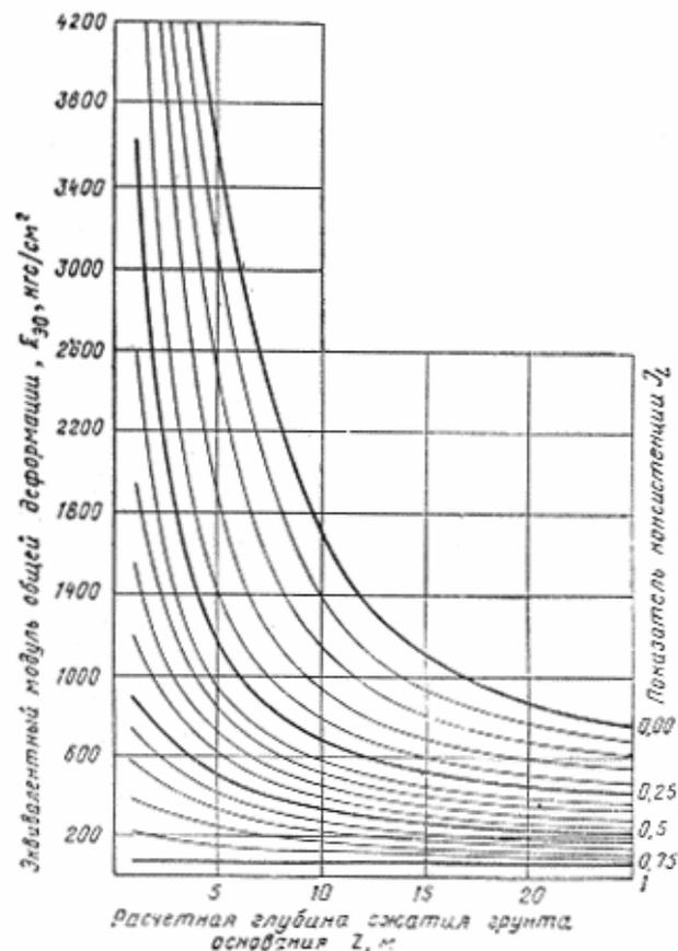
Рис. 2. График для определения эквивалентного модуля общей деформации глинистых грунтов
