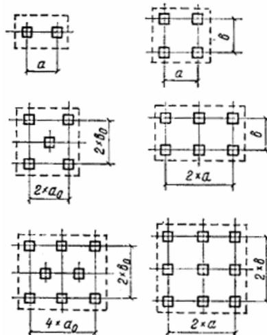
Рис. 25. Примеры решений свайных фундаментов под колонны промышленных зданий при различном числе свай в кусте
