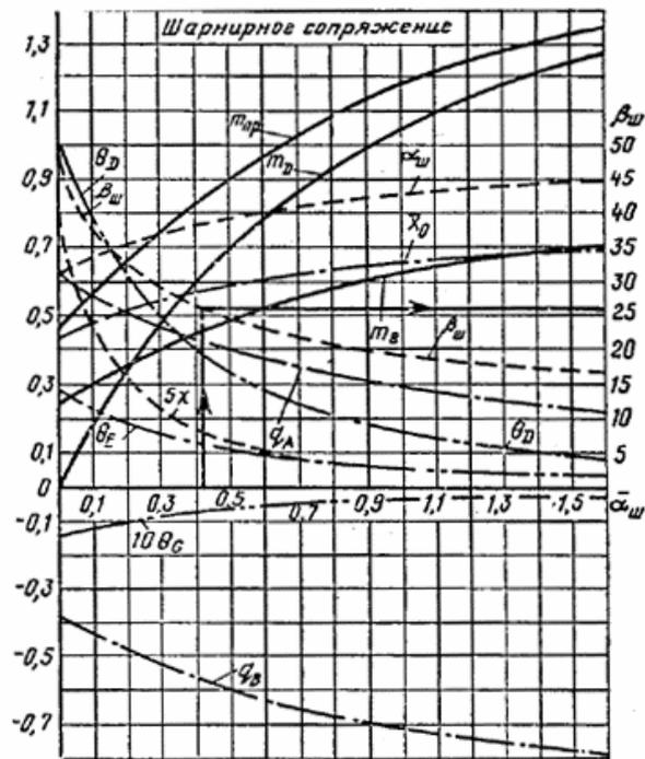
Рис. 48. График зависимости коэффициентов  $\alpha$ ,  $\theta$ ,  $q$ ,  $m$ ,  $\chi$  и  $\bar{X}_0$  (левая шкала) и  $\beta$  (правая шкала) от коэффициента  $\bar{\alpha}$  при шарнирном сопряжении голов свай с ростверком.
