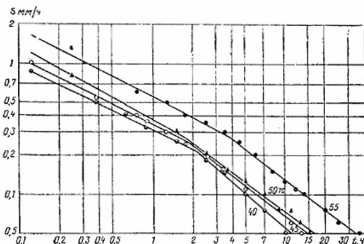
**Рис. 3.** Графики зависимости скорости осадки сваи от времени по ступеням нагрузки
