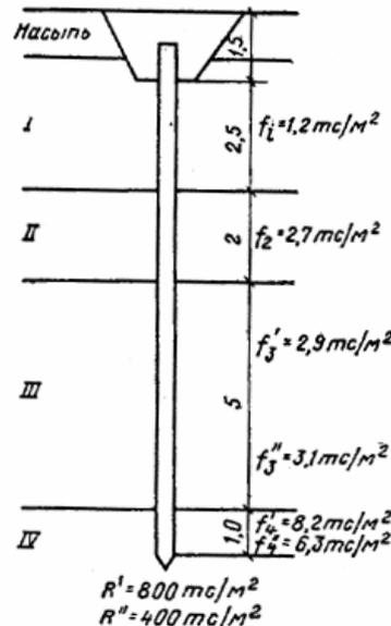
Рис. 9. Схема геологического разреза
