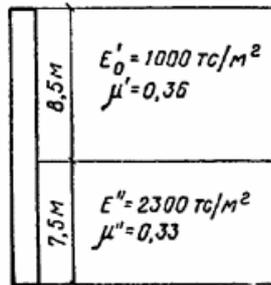
Рис. 2. Свая и деформативные параметры основания
