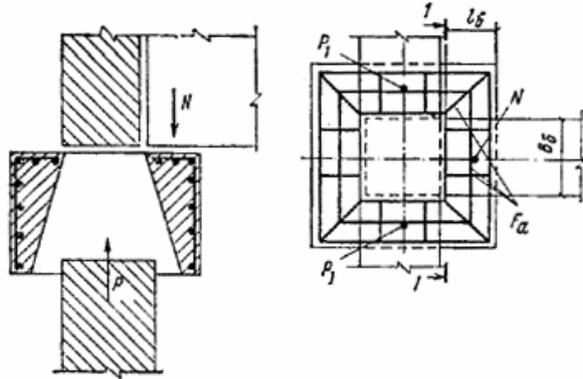
**Рис. 3. Расчет оголовка**
