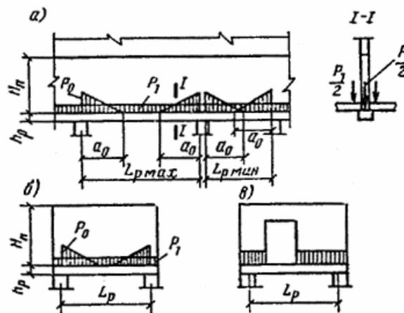
Рис. 1. Расчетные схемы ростверков
