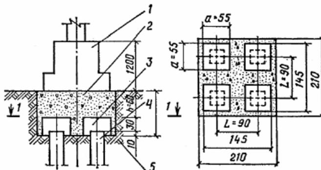
Рис. 52. Схема свайного фундамента с промежуточной подушкой
