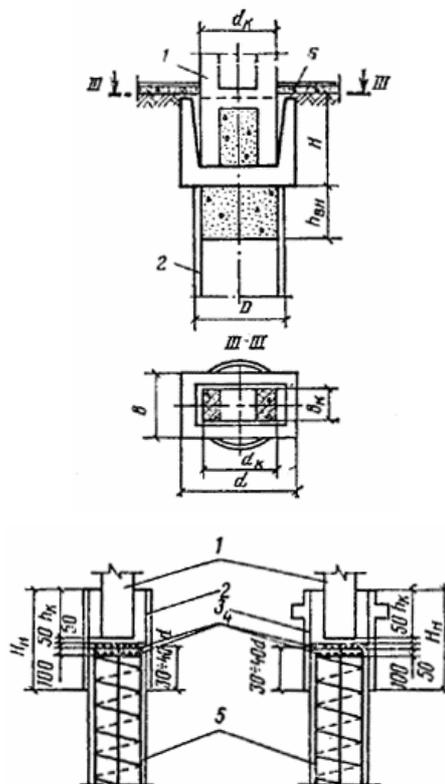
Рис. 38. Примеры сопряжении одиночных буронабивных свай с колонной
