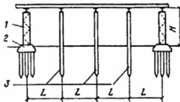
Рис. 28. Пример применения свай-колонн для технологических трубопроводов
