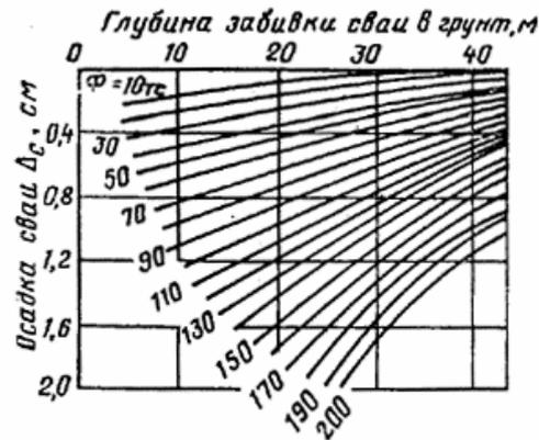
Рис. 3. График для определения осадки одиночной железобетонной сваи, погруженной в пески
