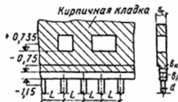
Рис. 6. Схема свайного ростверка
