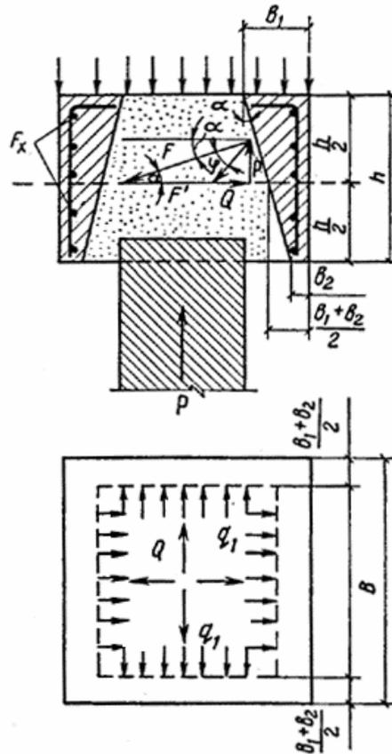
Рис. 2. Расчет оголовка
