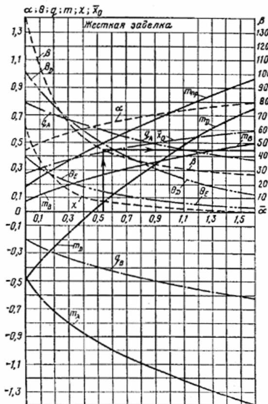
**Рис. 47. График зависимости коэффициентов  $\alpha$ ,  $\theta$ ,  $q$ ,  $m$ ,  $\chi$  и  $\bar{X}_0$  (левая шкала) и  $\beta$  (правая шкала) от коэффициента  $\bar{\alpha}$  при жесткой заделке голов свай в ростверк**
