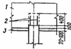
**Рис. 31. Пример конструктивного решения сопряжения свай со стержневой арматурой без предварительного напряжения, работающих на нормальные выдергивающие усилия, с монолитным железобетонным ростверком (заделка свай и арматуры проверяется расчетом)**
