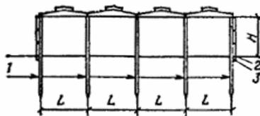
Рис. 27. Пример применения свай-колонн для одноэтажных производственных зданий
