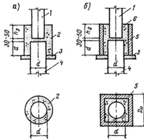
**Рис. 36. Примеры конструктивного решения сопряжения буронабивных свай диаметром 0,4 — 0,6 м, работающих на нормальные сжимающие усилия (не более 25 тс), не выходящие за пределы ядра сечения сваи, со сборными колоннами одноэтажных малонагруженных зданий (например, сельскохозяйственного назначения)**
