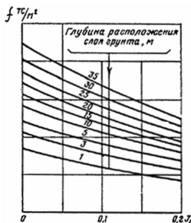
Рис. 3. Расчетные сопротивления глинистых грунтов на боковой поверхности свай и свай-оболочек  $f$  с консистенцией  $0,2 \geq I_L \geq 0$
