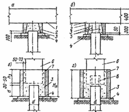
**Рис. 34. Примеры конструктивного решения сопряжения железобетонных свай квадратного (сплошного и с круглой полостью) сечения, работающих на нормальные сжимающие усилия, не выходящие за пределы ядра сечения свай, с ростверком или с колонной**
