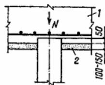
Рис. 30. Пример конструктивного решения сопряжения железобетонных свай, работающих на нормальные сжимающие усилия, не выходящие за пределы ядра сечения свай, с монолитными (кустовыми и ленточными) ростверками при погружении свай до проектной отметки
