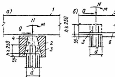
**Рис. 35. Пример конструктивного решения сопряжений железобетонных свай с предварительно-напряженной арматурой, работающих на вертикальные сжимающие и поперечные усилия и моменты, а также на внецентренные сжимающие нагрузки, выходящие за пределы ядра сечения сваи, с ростверком**
