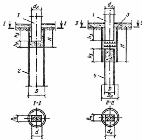
Рис. 37. Примеры сопряжения одиночных полых круглых свай и свай-оболочек с колонной
