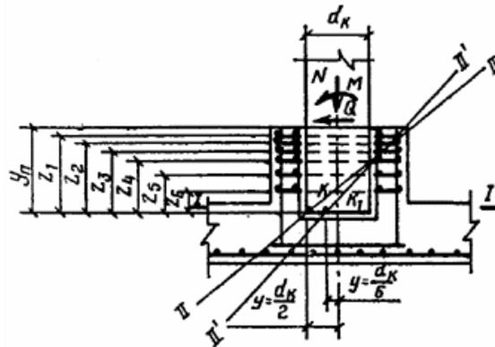
Рис. 4. Схема расчета продольной арматуры стенок стакана
