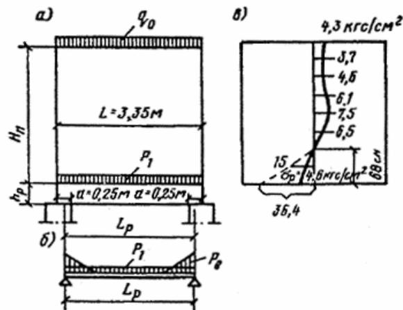
Рис. 2. Схема для расчета ростверка
