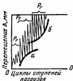
Рис. 17. График циклических перемещений сваи
