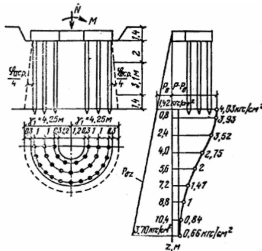
Рис. 23. Расчетная схема свайного фундамента
