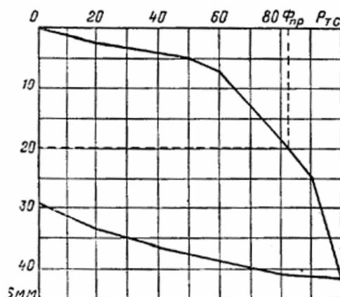
Рис. 16. График испытания свай статической нагрузкой
