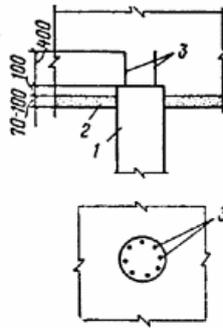
**Рис. 32. Пример конструктивного решения сопряжения буронабивной свай, работающей на нормальную сжимающую нагрузку, не выходящую за пределы ядра сечения свай, с монолитным железобетонным ростверком**
