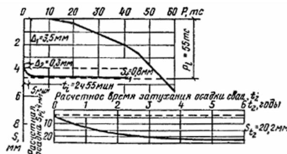
Рис. 1. Схема расчета осадки сваи
